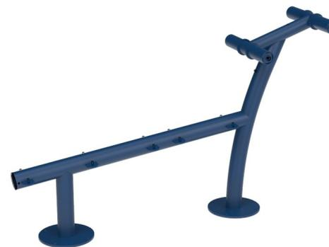
Tous les composants en acier sont fabriqués en acier au carbone, avec une surface galvanisée à chaud selon ISO1461, et un revêtement en poudre classe de corrosion C3 selon ISO12944-2. La teneur en plomb pour les surfaces est inférieure à 90 ppm et inférieure à 100 ppm pour le matériau de base.
