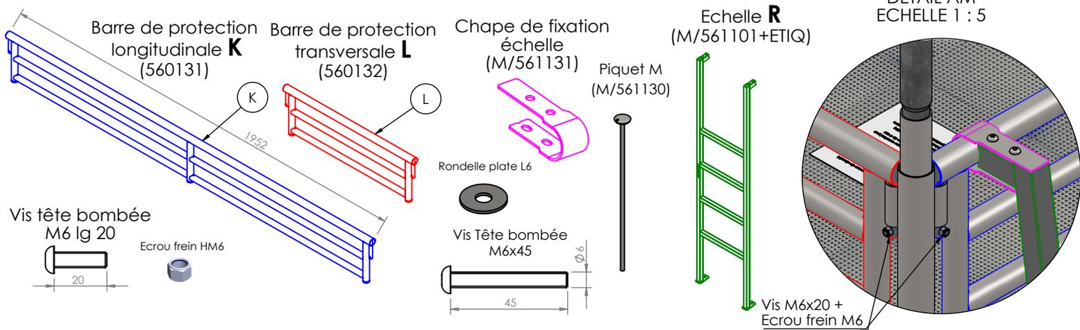
**1- Monter les barres de protection longitudinales K et transversales L sur les couchettes supérieures suivant les modèles ci-dessous et boulonner avec les vis tête bombée M6x20 et écrous frein M6 suivant le détail AM (positionner les têtes de vis du côté intérieur de la couchette)**
