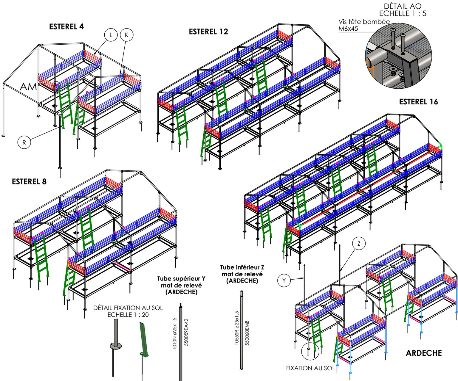
**3- Fixation au sol : l'armature et les échelles doivent IMPERATIVEMENT être fixés au sol soit avec les piquets M fournis (1 piquet par pieds et 2 piquets par échelle) soit à l'aide de tirefonds M6x40 + rondelles plates (non fournis) si fixation sur plancher bois**
