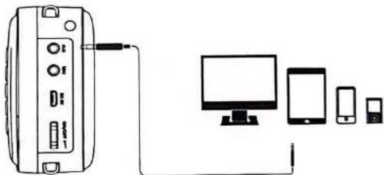
En connectant l'amplificateur à un appareil audio externe (ordinateur/téléphone portable/MP3/MP4) via un câble AUX, l'amplificateur jouera de la musique dans les appareils ci-dessus lorsque l'écran LCD affichera « LINE » avec une voix d'invite « Audio In mode »
